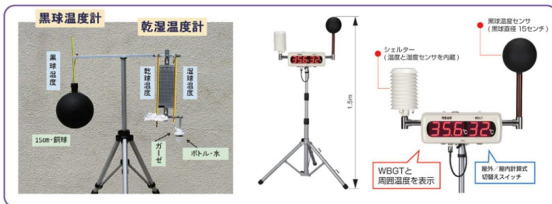
図7 暑さ指数 (WBGT) 測定装置 左は基本型、右は電子式のもの
